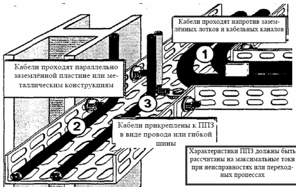
Рисунок 20 - Прокладка кабелей вдоль параллельных проводников заземления.
