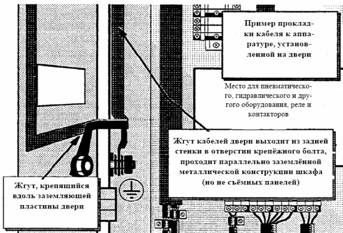
Рисунок 3 - Укладка кабелей, идущих к устройствам управления и электронным устройствам, установленным на двери, в шкафу управления.
